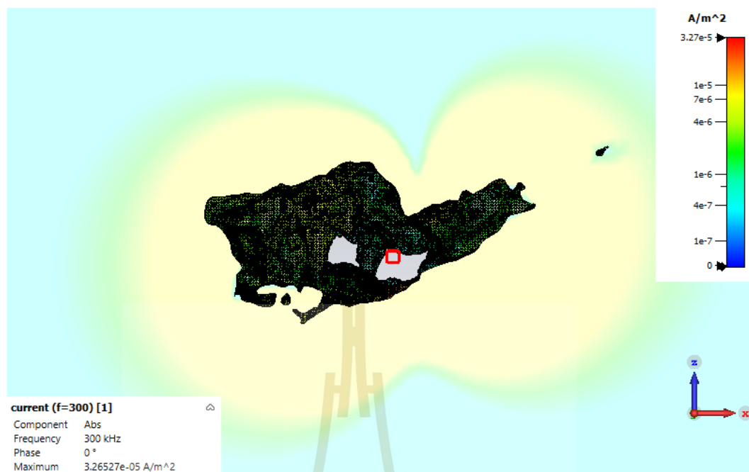
รูปที่ 4.25 การจำลองความหนาแน่นกระแสของแบบจำลอง 3 มิติของถ้ำเชียงดาวด้วยโปรแกรม CST ที่ความถี่ 300 kHz
