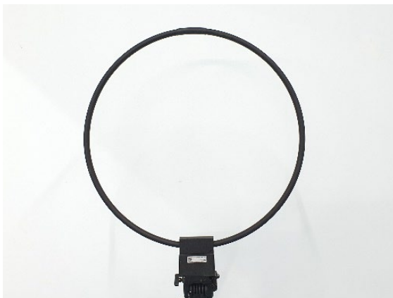
รูปที่ 3.1 สายอากาศบ่วง Passive shielded (20 Hz–1 MHz AH Systems SAS-565L)
