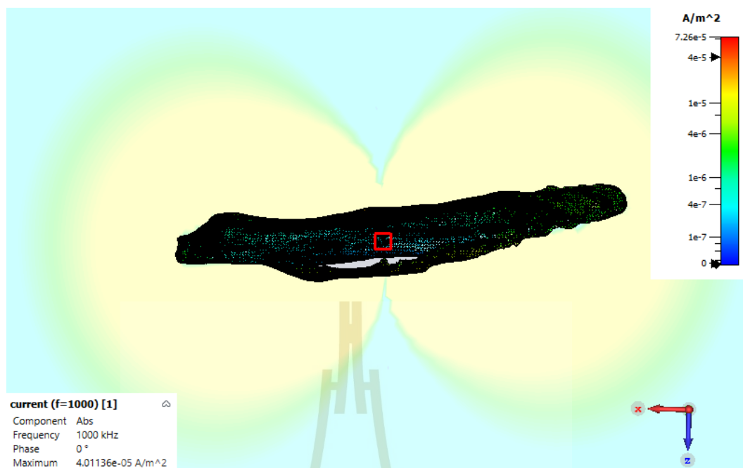
รูปที่ 4.31 การจำลองความหนาแน่นกระแสของแบบจำลอง 3 มิติของถ้ำปาฏิหาริย์ด้วยโปรแกรม CST ที่ความถี่ 1000 kHz
