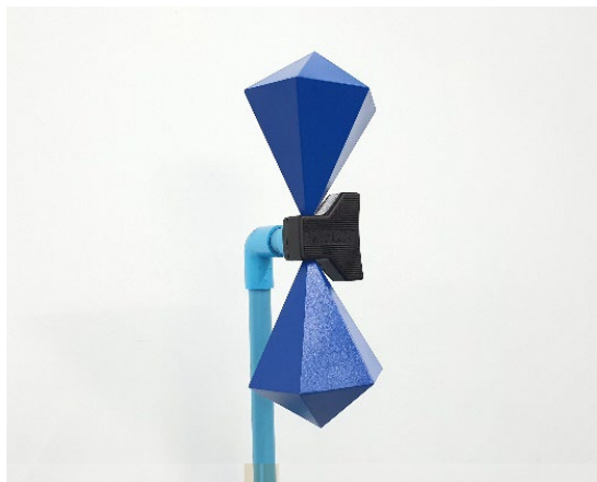
รูปที่ 3.4 สายอากาศแบบกรวยสองฝั่ง Biconical (20 MHz–1 GHz Aaronia BicoLOG 20100)
