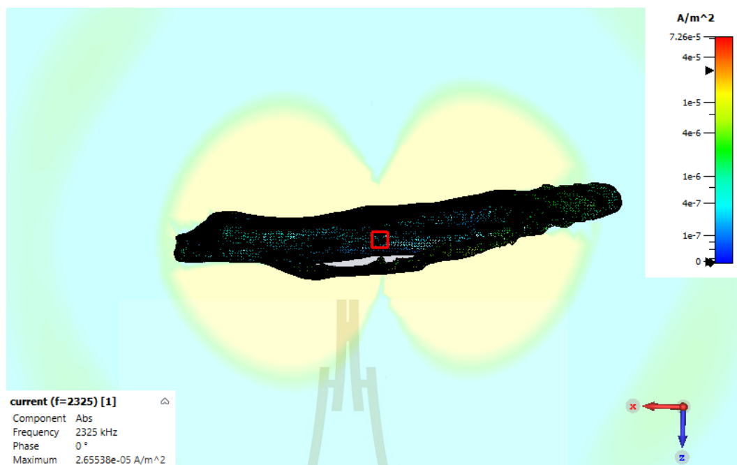
รูปที่ 4.33 การจำลองความหนาแน่นกระแสของแบบจำลอง 3 มิติของถ้ำปาฏิหาริย์ด้วยโปรแกรม CST ที่ความถี่ 2325 kHz
