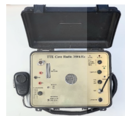
รูปที่ 13 เครื่องวิทยุสื่อสาร 350 kHz ต้นแบบที่พัฒนาขึ้นมา
